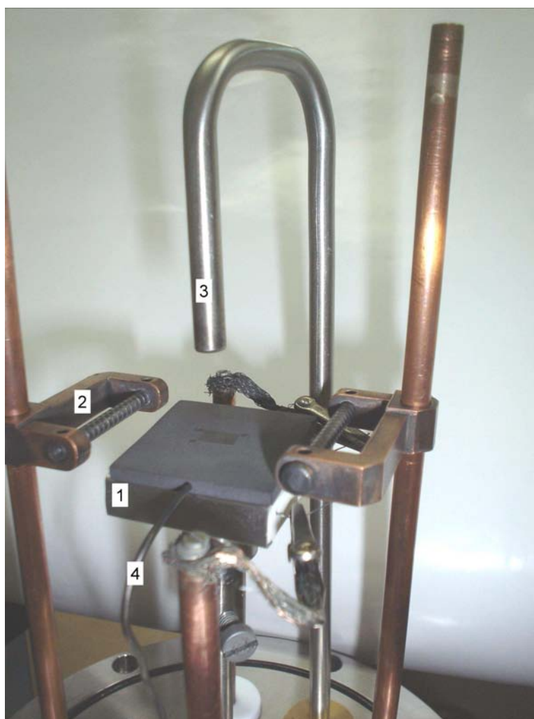
FIGURA 3.2 Foto do reator HFCVD utilizado. Internamente estão: (1) Suporte de substrato; (2) Suporte de filamento; (3) Entrada de gases; (4) Termopar.
